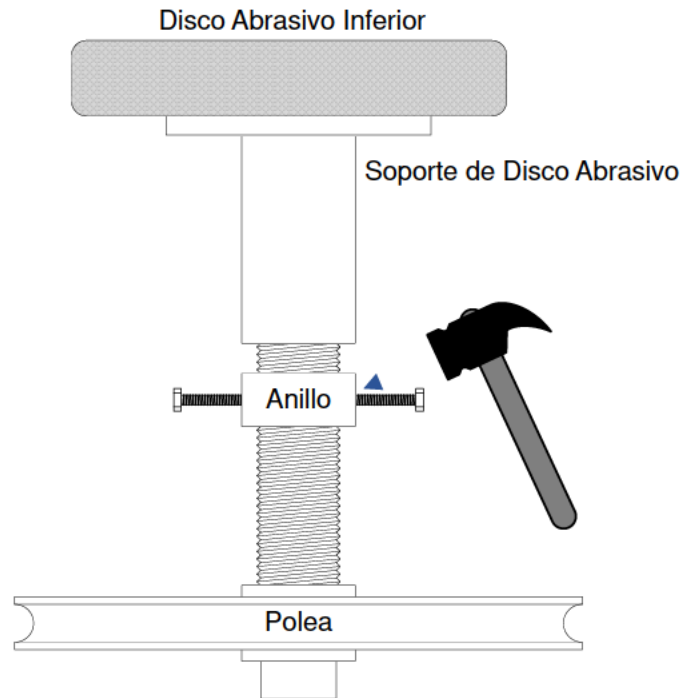
Figura 3: Método de liberación de anillo de sujeción de la piedra abrasiva inferior, para su calibración
